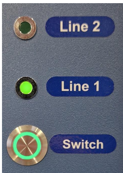
Figura 20.2 O interruptor de alteração de linha da incubadora FIV multicâmara MIRI® TL12 e uma Linha 1 ativa
