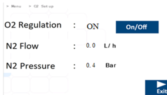
Figura 16.4 Vista do submenu de regulação de N 2 nas incubadoras FIV multicâmara MIRI® TL6 e MIRI® TL12
