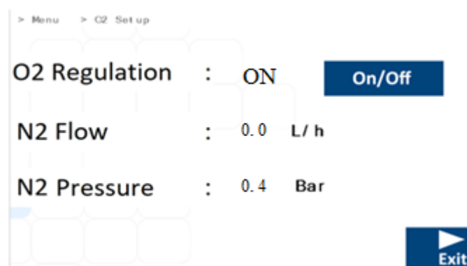
Figura 13.26 Vista do submenu de regulação de O 2 nas incubadoras FIV multicâmara MIRI® TL6 e MIRI® TL12
